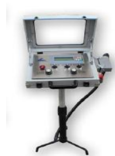
Fig. 8: Quadro di comando mobile con cavo elettrico da collegare alla tagliatrice
