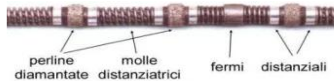
Fig. 11: Filo diamantato (assemblaggio con molle)
