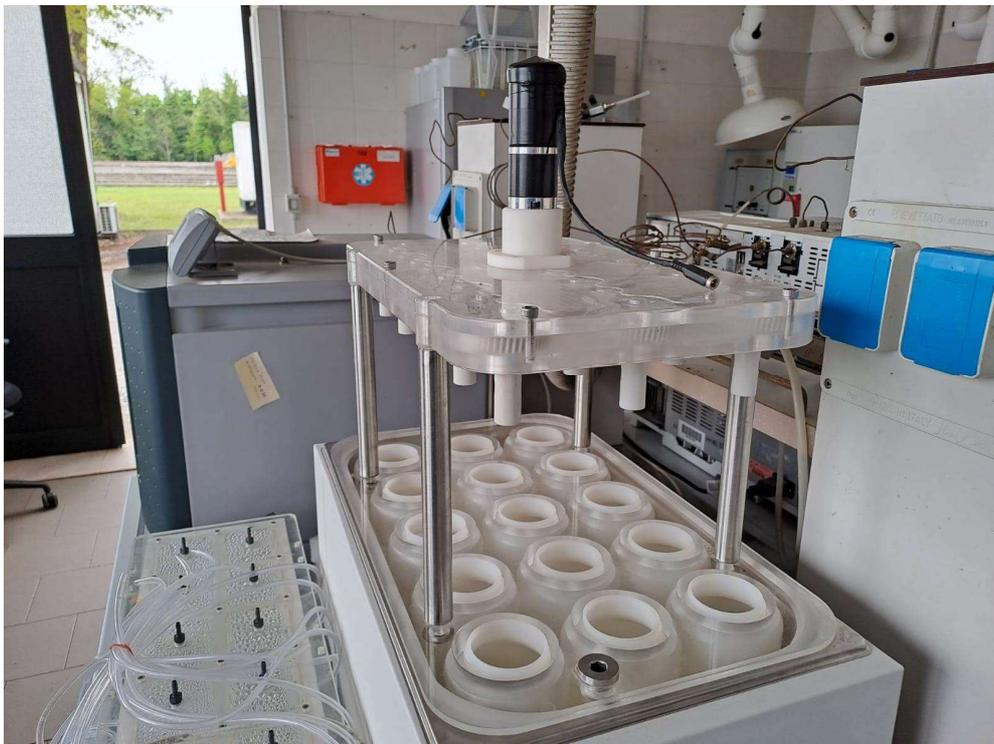
Figura 4: Fermentatore Batch, Nautilus
