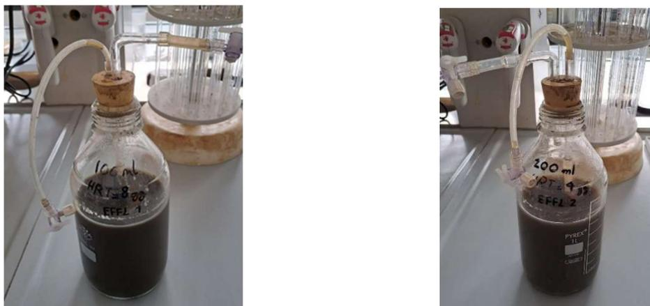
Figura 5: Reattori semicontinui utilizzati nel processo di Chain Elongation
