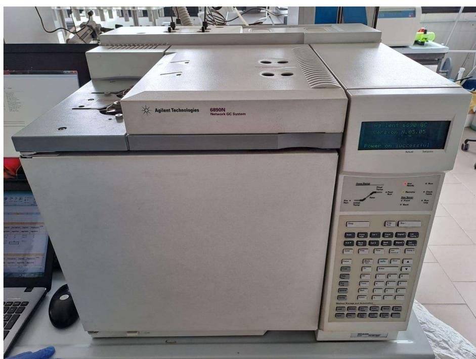
Figura 7: Gascromatografo Agilent 6890N
