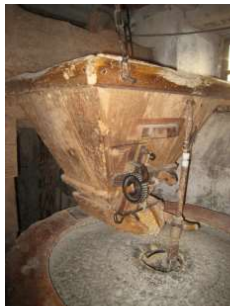
Fig. 28- Particolare della tramoggia in funzione, mulino di Casto (foto Bazzani)
