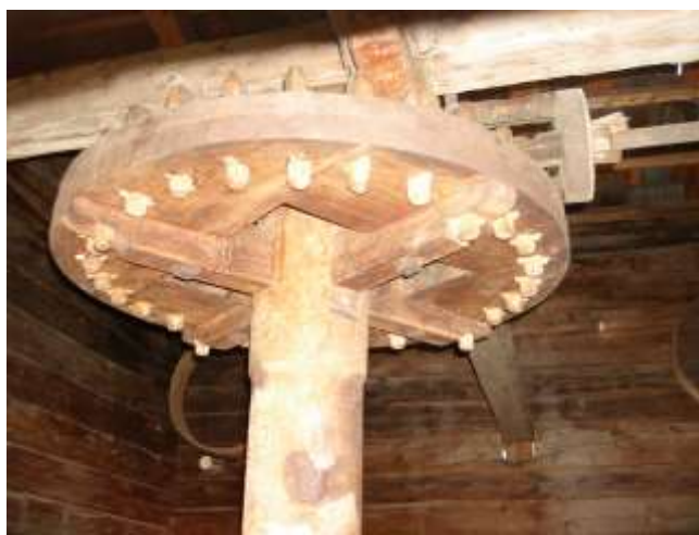
Fig. 21 in entrambe le foto si vedono il lubecchio e la lanterna, mulini di Brunico (foto Bazzani)
