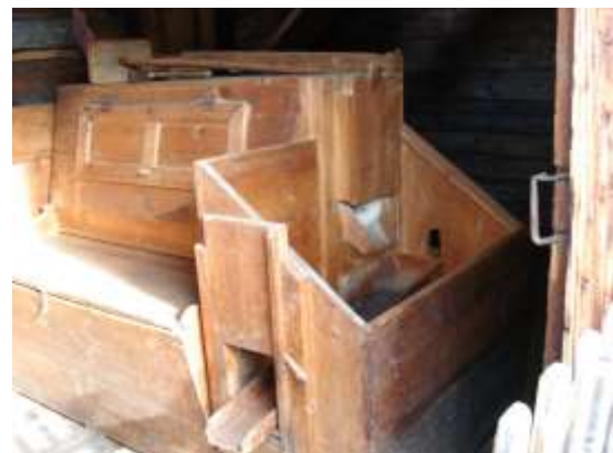
fig. 26- particolare del cassone per la farina, mulino di Casto (foto Bazzani)
