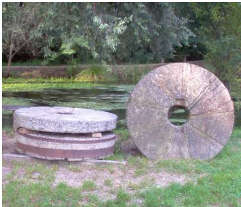
Fig. 24- Macine del mulino di Cervara, è possibile vedere le scanalature praticate sulla superficie dette “aguzzatura” (foto Bazzani)
