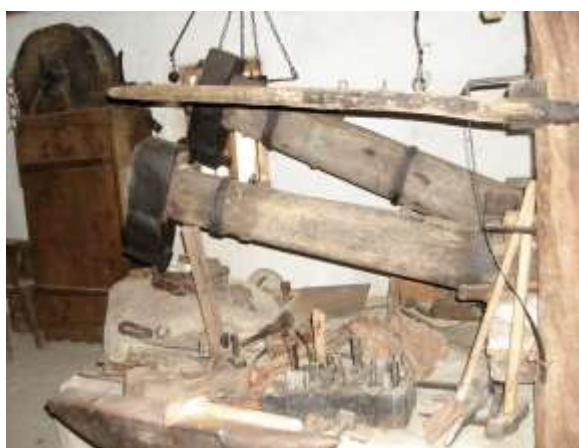
Fig. 40- particolare del maglio, Fucina di Brunico (foto Bazzani)
