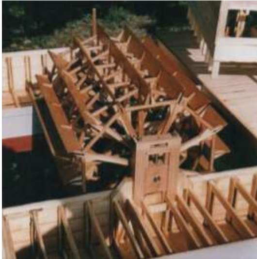
Fig.10 -Ricostruzione di un mulino natante, particolare della ruota (da Trevisan, 2010 7)
