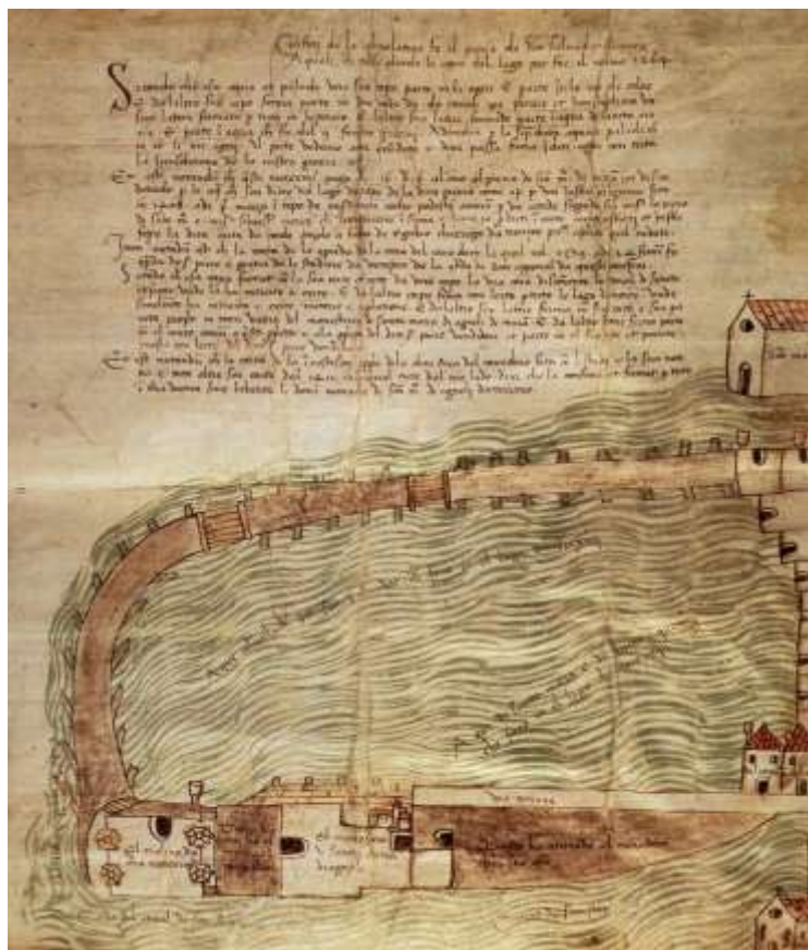
Fig. 2- Il disegno ci mostra la struttura del mulino, provvisto di 4 ruote; la grande diga delimita il lago Morosini presso S. Cipriano, su di essa sono ben visibili le paratoie utilizzate per far entrare ed uscire l'acqua utilizzata per azionare le ruote del mulino. (ASVe, S. Maria degli Angeli di Murano, b. 32, XV secolo)
