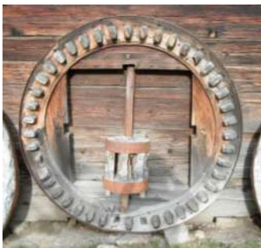
Fig. 21 in entrambe le foto si vedono il lubecchio e la lanterna, mulini di Brunico (foto Bazzani)
