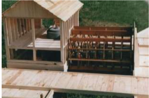
Fig.11 – Ricostruzione di un mulino natante, particolare della pedana di unione dei due scafi, p. della ruota e della macina. (da Trevisan, 2010)
